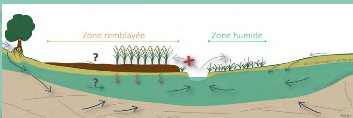
Figure 1 - Exemple de l'effet du remblaiement non imperméable sur les fonctions hydrologiques de la zone humide en bord de cours d'eau (FMA).
